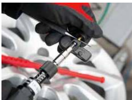
Strângerea valvei pe senzorul de verificare a presiunii cu 1,4 Nm Art.-Nr. 714 71 91
