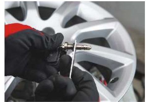
Montați etanșarea utilizând partea inel.
