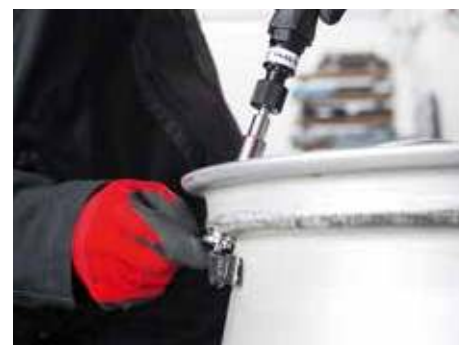
Strângerea piuliței cu 8 Nm la montajul senzorului de verificare a presiunii. Art.-Nr. 714 71 92
