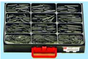
Trusă buce elastice DIN 1481: pentru solicitari puternice, din otel pentru arcuri. /12 dimensiuni de la 2 x 20 la 6 x 60 mm = 1100 buc. Art.-Nr. 964 475
