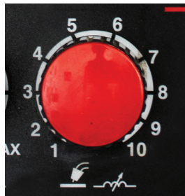
Reglaj fin curent inducție pentru cordon sudura calitativ
