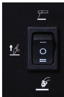
3 moduri diferite de sudare - MIG, STICK și LIFT/TIG
