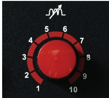
Sistem reglaj continuu inducție pentru cordon sudură „perfect- estetic”
