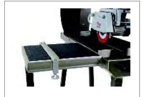
Fig. 4: O masă laterală opțională, cu opritoare, oferă o variantă de suport solid, pentru materiale de mari dimensiuni.
