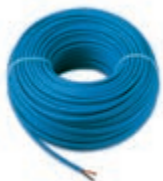
01840.B Cablul pentru difuziune sonoră 2x0,50 mm 2 , tensiune nominală spre pământ 400 V, adecvată pentru instalarea cu cabluri de Categoria I,albastru - 100 m
