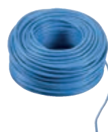
732H/100 Cablu Due Fili Plus pentru montare la interior, conductoare torsadate 2x1 mm 2 , înveliș din PVC, temperatură de funcționare -25/+70 °C, grad de izolare 450/750 V, nu este adecvat pentru trecerea prin canale îngropate - rolă de 100 m
