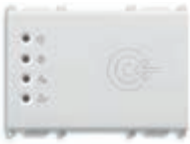
14457 Cititor de carduri cu transponder, pentru instalare la exteriorul încăperii, standard KNX, 2 ieșiri pe releu NO 4 A 24 V~, 2 intrări, 12-24 V~ 50/60 Hz și 12-24 Vdc (SELV) - 3 module. Furnizat fără card cu transponder. Adâncime: 36 mm
