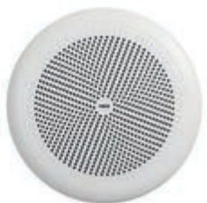
01906 Difuzor pasiv sonor IP55 8 Ω 30 W, instalare pe pereți ușori și tavane false. Adâncime: 70 mm
