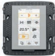
21848.1.BN Ecran tactil color 4,3", Full Flat, pentru control și comandă, cu intrare senzor temperatură, cu suport pentru instalarea în casete 8 module. Adâncime: 40 mm
