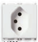
14226 2P+T 10 A, Elvețian, tip 13 - 2 module. Adâncime: 41 mm
