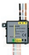
01476 Modul cu 2 intrări digitale programabile pentru contacte fără potențial, 1 ieșire pentru o jaluzele cu lamele orientabile cu releu pentru motor cosφ 0,6 2 A 120-230 V~, 2 ieșiri pentru pilotare LED, domotică By-me, instalare prin încadrare (modul posterior)
