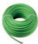
732I/100 Cablu Due Fili Plus pentru montare la interior/exterior, conduc- toare torsadate 2x1 mm 2 , izolator și înveliș LSZH, temperatură de funcționare -25/+70 °C, grad de izolare 600/1000 V, adecvat pentru trecerea prin canale îngropate, în tuburi uscate sau cu posibilitatea de drenare (max 24 h de umiditate), nu este adekvat să fie îngropat direct - rolă de 100 m
