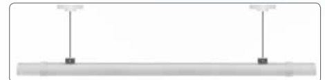
Opcjonalnie instalacja oprawy na zawieszakiach Optional installation of the luminaire on the slings
