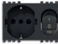
19276 16 A P30 250 V~, 1P+N C 16 - 3 module. Adâncime: 39,6 mm
