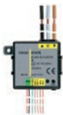
01476 Modul cu 2 intrări digitale programabile pentru contacte fără potențial, 1 ieșire pentru o jaluzea cu lamele orientabile cu releu pentru motor cosφ 0,6 2 A 120-230 V~, 2 ieșiri pentru pilotare LED, domotică By-me, instalare prin încadrare (modul posterior)
