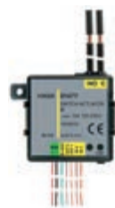
01477 Modul cu 2 intrări digitale programabile pentru contacte fără potențial, 1 ieșire cu releu cu comanda luminilor NO 10 A 120-230 V~ 50/60 Hz, 2 ieșiri pentru pilotare LED, domotică By-me, instalare prin încadrare (modul posterior)
