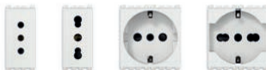
19201.B 10 A, P11. Adâncime: 25,3 mm 19203.B Bpresa 16 A, P17/11. Adâncime: 25,3 mm 19209.B 16 A, P30 - 2 module. Adâncime: 29 mm 19210.B 16 A, universală - 2 module. Adâncime: 26 mm
