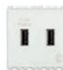
19295.B Alimentator 5 V 2,1 A, 2 ieșiri USB care furnizează în total 2,1 A, 1 USB, 120-230 V~ 50/60 Hz - 2 module. Adâncime: 37 mm
