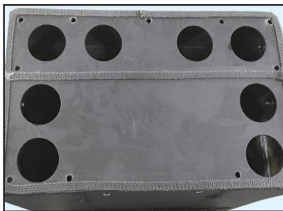
Scheme 7. Demontarea capacului pentru țevile de fum-2
