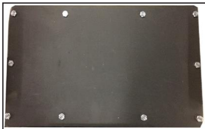
Scheme 6. Demontarea capacului pentru țevile de fum-1
