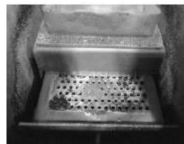
Grătar murdar și găuri înfundate
