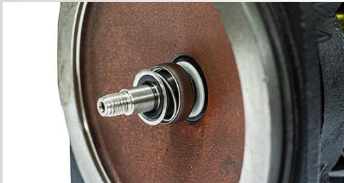
Garnitura mecanică: ceramică/grafit/NBR
