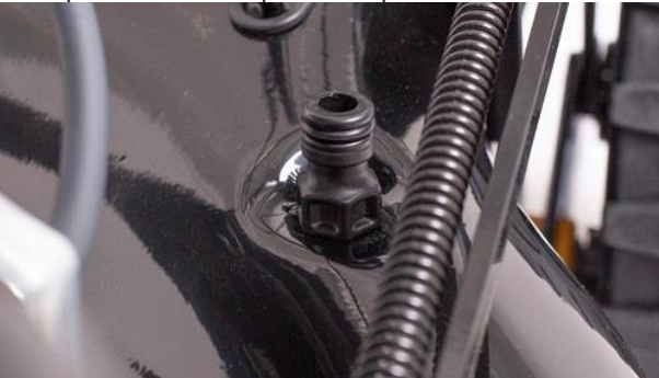
Echipata cu mufa pentru spalare ce usureaza curatarea echipamentului dupa utilizare
