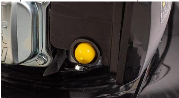
Pompa de amorsare ce faciliteaza pornirea usoara a motorului
