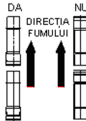
Imaginea 7. Modul de montare a țevilor de fum
