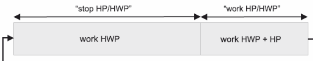
Fig. 8. Functionare pompa in timpul incalzirii apei calde in modul prioritate
