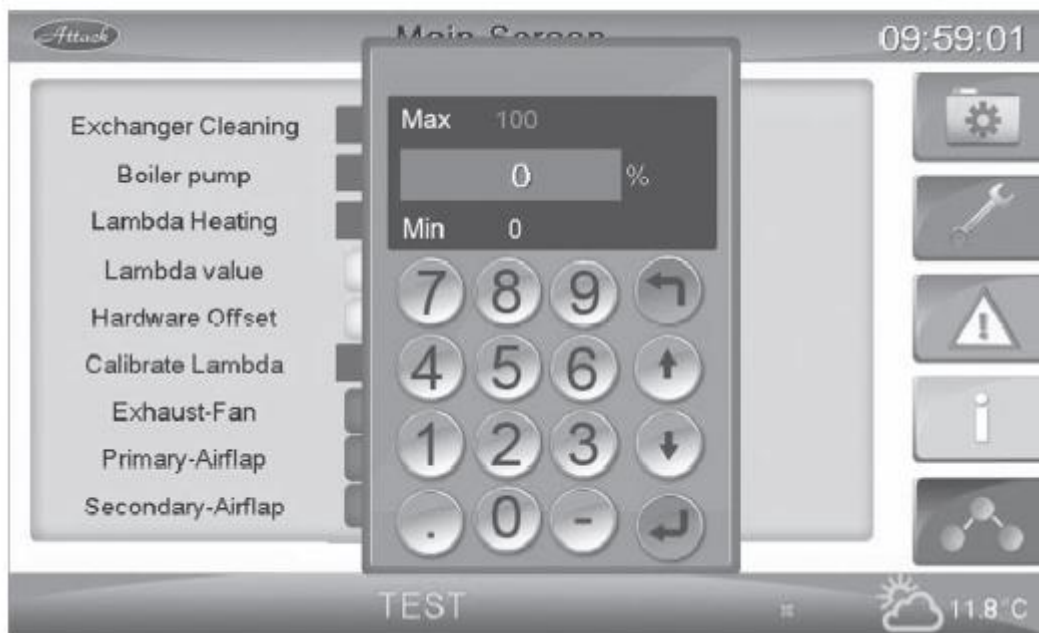
Fig. 23 Activarea dispozitivelor pentru testare impiedica efectuarea modificarilor la acestea (Modularea)
