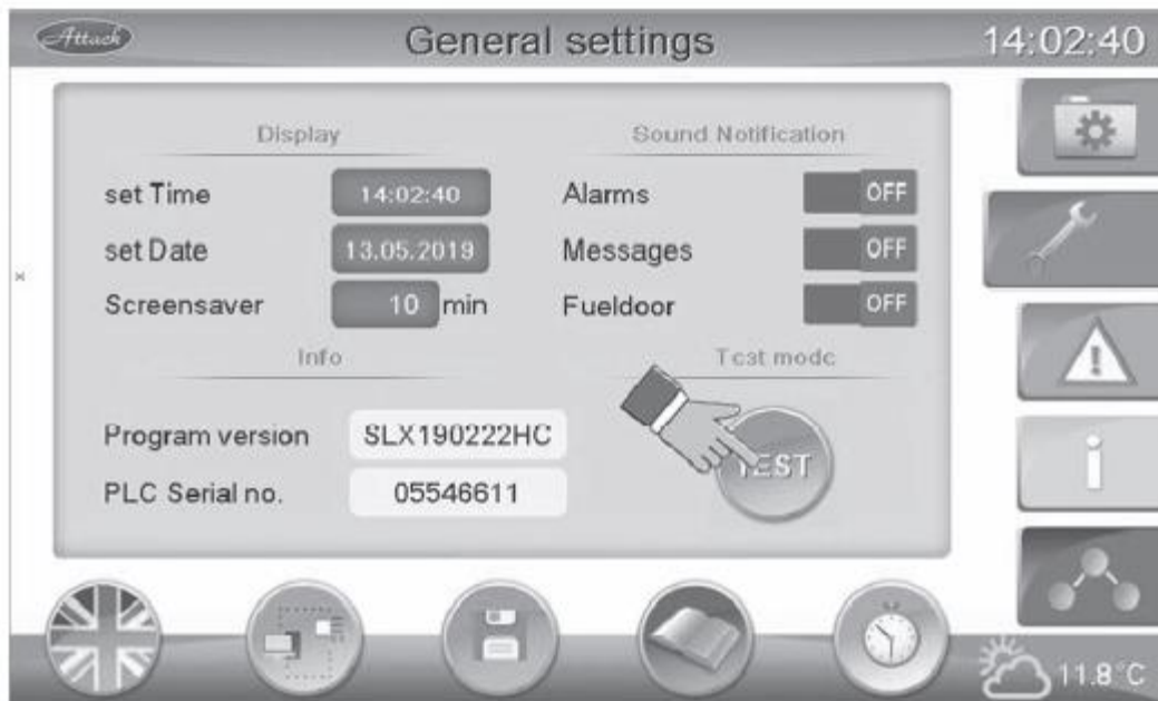
Fig. 20 Intrarea in TESTMODE – regim de testare
