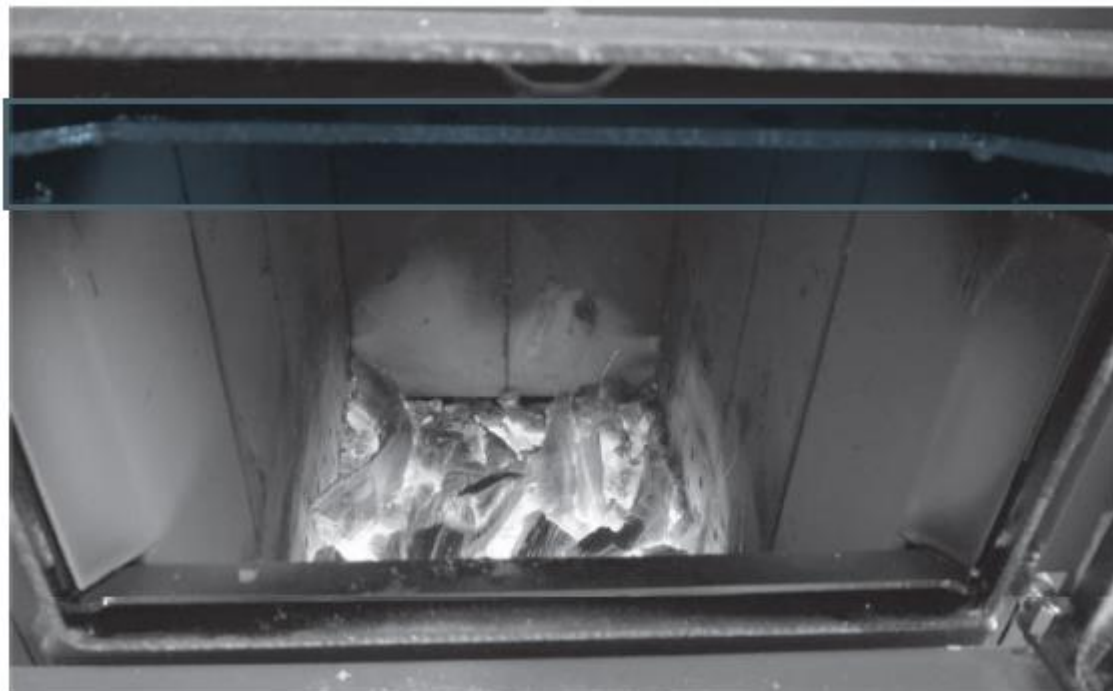
Fig. 13 Inaltimea stratului de jaratec adecvat
