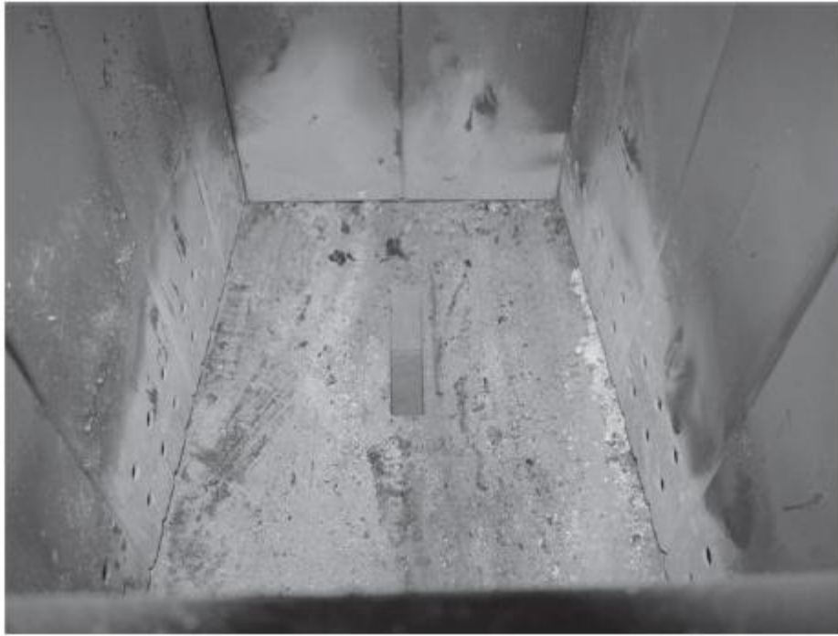
Fig. 6 Camera de alimentare curatata corect
