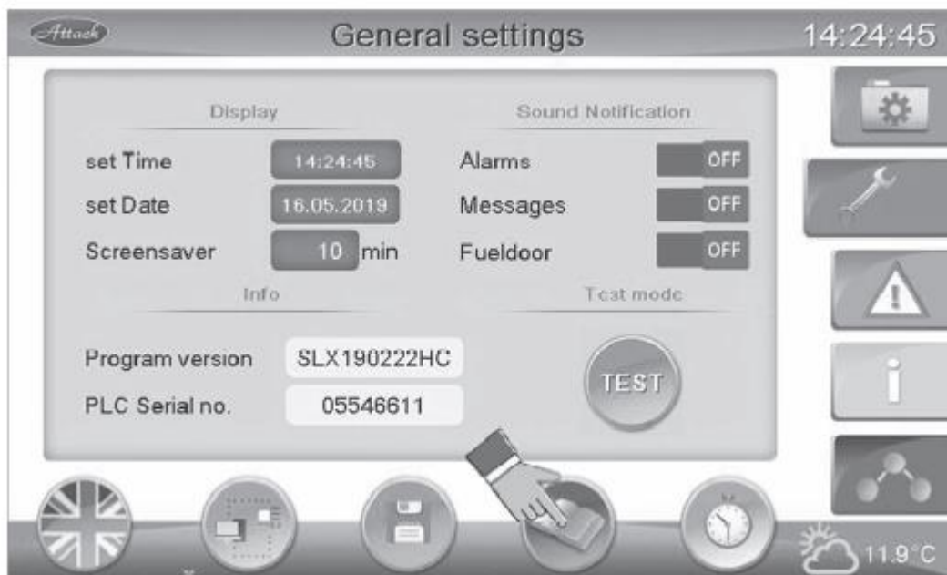
Fig. 52 Intrati in meniul setarilor de service Dand click pe Setarile de service, se va afisa tastatura in care se va introduce codul de service "7319" .
