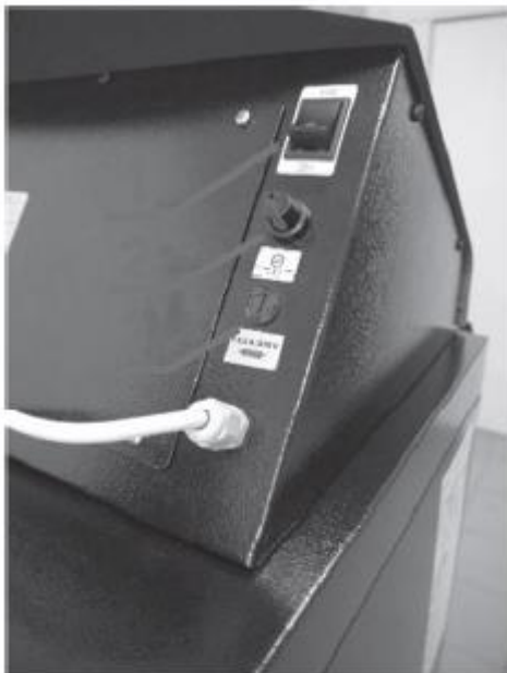
Fig. 17 1 – comutator principal, 2 – termostat de siguranta, 3 – siguranta fuzibila (F6, 3A)
