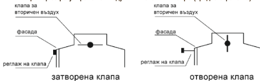
Фиг. 4. Пример за регулиране на въздушния поток към пещта (предна страна на)
