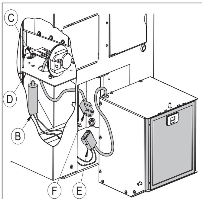
3) Infilare il condensatore (B) nell'apposito foro, fissarlo con il bullone (C) e collegare il connettore (E) con il connettore (F). Spingere infine il ventilatore verso l'interno fino a fine corsa.
