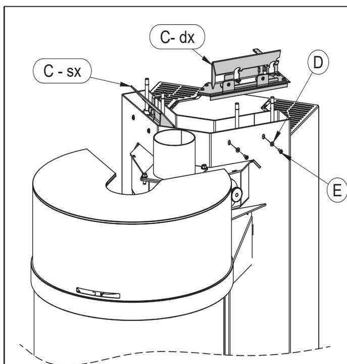
6) Inserire i deflettori (C – sx) e (C – dx). Aprire la porta scorrevole della camera di combustione (a tal proposito fare riferimento al capitolo dedicato) e fissare i due deflettori con le 4 viti (E) e le 4 rondelle (D). Rimontare in seguito il top in ghisa (B).
