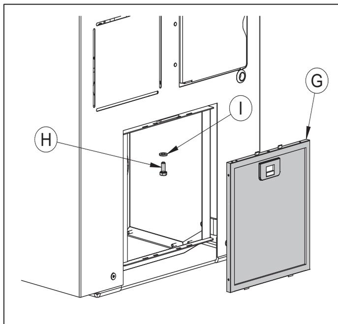
4) Rimuovere il filtro (G) e fissare il ventilatore nella parte alta attraverso il bullone (H) e la rondella (I).
