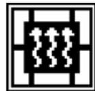
Visualizza l'esclusione della ventilazione, ovvero il ventilatore ambiente è disabilitato. Tuttavia, qualora il corpo stufa salisse di temperatura, il ventilatore si attiverà forzatamente e aumenterà la potenza di ventilazione all'aumentare di tale temperatura, visibile dalle barrette accese attorno al simbolo. Una volta scesa sotto una certa soglia il ventilatore ambiente si disattiverà automaticamente.
