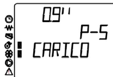
Apasand si mentinand apasata tasta 2, va fi vizualizat urmatorul afisaj. Aici puteti afla informatii despre temperatura gazelor arse, regim de functionare, soba, vitezele ventilatorului pentru canalizare si disiparea caldurii (optional). Numai prin mutarea degetului de pe tasta, displayul va reveni la meniul principal.
