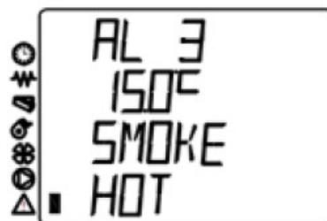
**Temperatura prea ridicata a gazelor arse.** Daca temperatura gazelor arse nu este scazuta, si cand este afisat mesajul **HOT EXHAUST** (trad.: GAZE ARSE FIERBINTI), soba va continua sa functioneze intr-un regim minim pana cand temperatura scade sub 280°C. Daca temperatura depaseste 280°C, soba va raporta o eroare **AL3 HOT SMOKE**.
