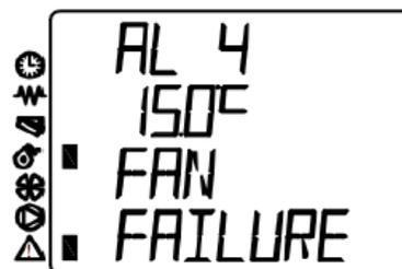
**Eroare cauzata de functionarea defectuoasa a ventilatorului de evacuare a gazelor arse.**
