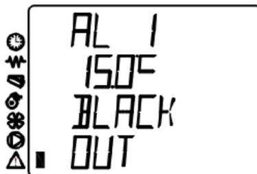
**Anulati alarma** apasand lung tasta 4 si apoi asteptati ca soba sa se raceasca (daca este calda) si pe display este afisat nota **cleaning final**. Dupa cateva minute, reporniti (porniti ON apasand tasta 4) soba.
