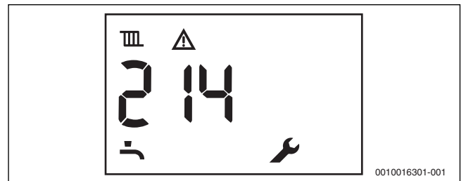
Fig. 4 Exemplu de cod de defecțiune
