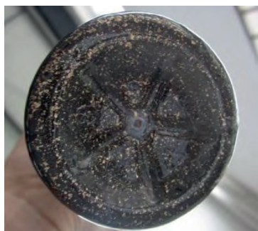
Fig. 70 Ulei care conține particule de cupru
