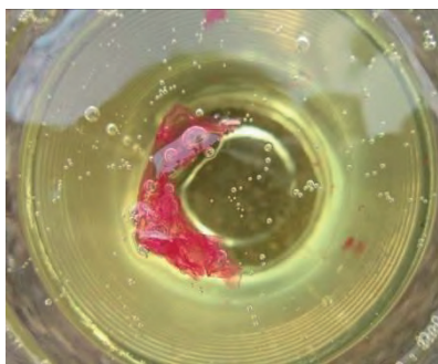
Fig. 69 Ulei care conține impurități ce ar putea înfunda filtrul
