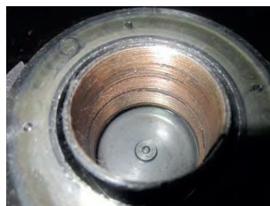
Fig. 74 Disc cu filet plan uzat
