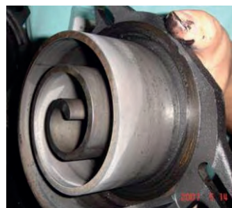
Fig. 73 Disc cu filet plan uzat
