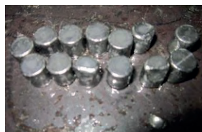
Fig. 76 Rulmenți de compresor uzați și deteriorați
