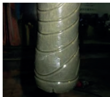
Fig. 70 Ulei tulbure și gri care indică funcționarea anormală a sistemului Următoarele figuri arată efectele uleiului poluat.
