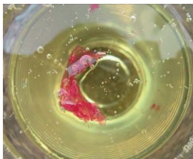
Fig. 68 Ulei care conține impurități ce ar putea înfunda filtrul
