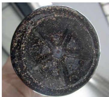
Fig. 69 Ulei care conține particule de cupru
