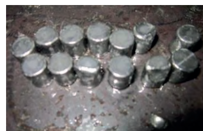
Fig. 75 Rulmenți de compresor uzați și deteriorați
