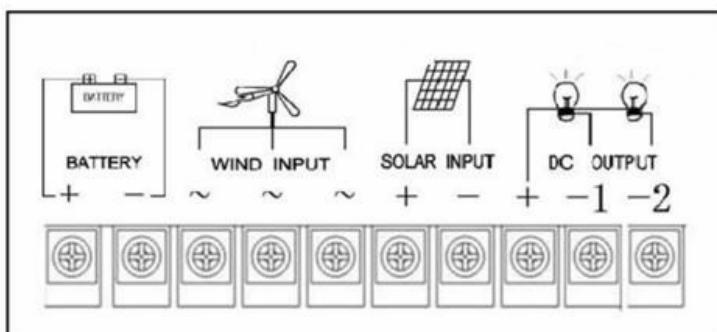
**Schema de conexiuni a bornelor controlerului**
