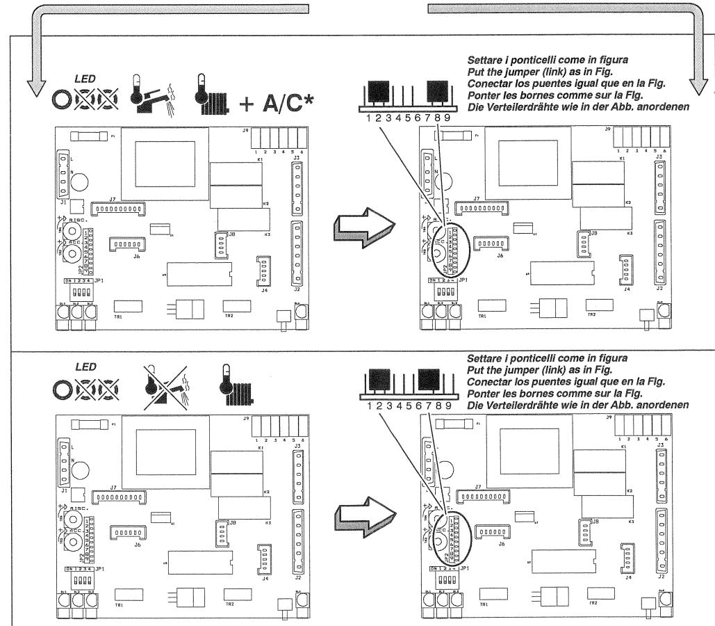
**Scheda guasta Faulty PCB Tarjeta dañada
