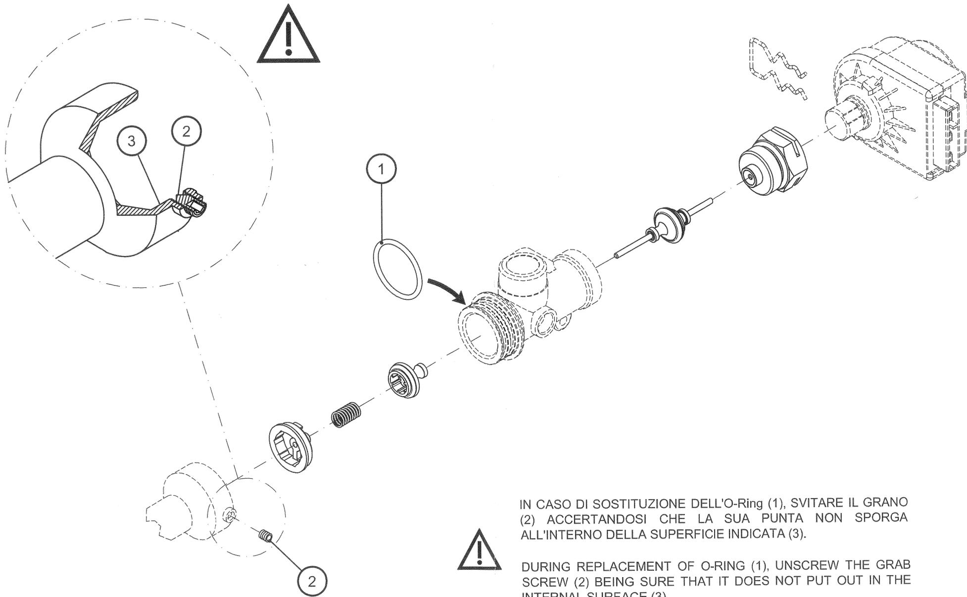
IN CASO DI SOSTITUZIONE DELL'O-Ring (1), SVITARE IL GRANO (2) ACCERTANDOSI CHE LA SUA PUNTA NON SPORGA ALL'INTERNO DELLA SUPERFICIE INDICATA (3).
