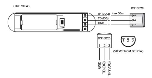
Figure 4.10: Door Window Sensor - connection to DS18B20 Sensors
