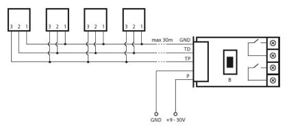
Figure 4.5: DS18B20 temperature sensors connection diagram
