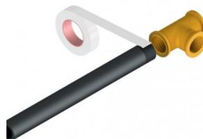
Verificare che non vi sia eccedenza di materiale aggiunto per prevenire possibili rotture per l'eccessivo serraggio.
