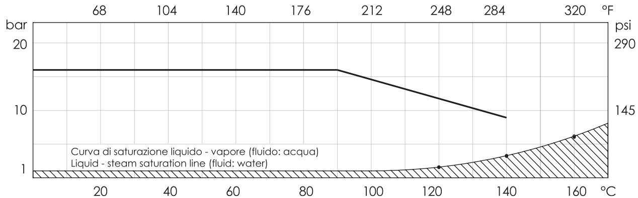
NON ADATTA PER VAPORE. NON utilizzare in condizioni di temperatura e pressione al di sotto della curva di saturazione liquido-vapore (area tratteggiata)
