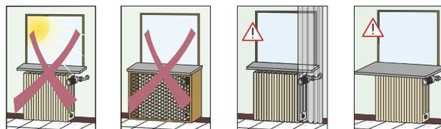
**Si consiglia** di installare un sensore di temperatura ambiente in ogni zona nel caso di installazione in nicchie, cassonetti, dietro tendaggi, all'esposizione diretta dei raggi solari oppure sotto a mensole molto sporgenti che falserebbero il corretto rilevamento della temperatura.
