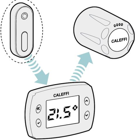
Il sensore di temperatura è opzionale in quanto il comando elettronico è già dotato di sensore di temperatura integrato. È consigliato l'uso del sensore in caso di installazione in situazioni che falserebbero il corretto rilevamento della temperatura. Esempio, in figura, sotto mensole molto sporgenti.
