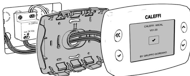
Posizionare la centralina secondo quanto specificato nel manuale di installazione e messa in servizio per evitare problemi di trasmissione del segnale.
