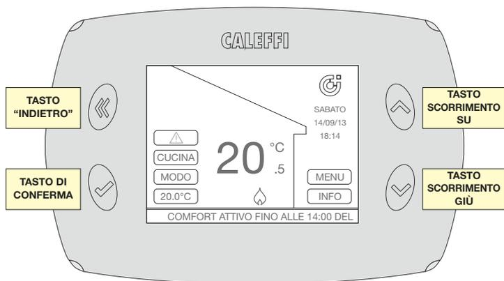
La centralina è dotata di quattro tasti e di un display illuminato a cristalli liquidi tramite i quali si può accedere ai vari menu per la visualizzazione dello stato dell'impianto e la sua regolazione. Sul menù vengono visualizzate tutte le informazioni relative allo stato della zona che si è scelta come "principale".
