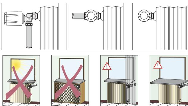
Si consiglia di installare i comandi cronotermostatici in posizione orizzontale. Il posizionamento verticale non consente un corretto rilevamento della temperatura, con conseguente imprecisione nella regolazione della temperatura ambiente.
