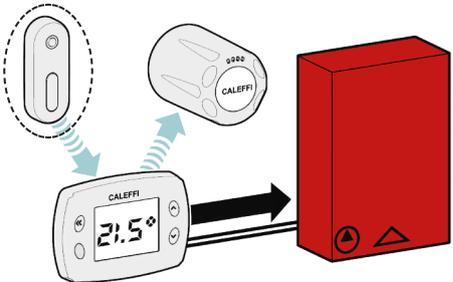
Il sensore di temperatura è opzionale in quanto il comando elettronico è già dotato di sensore di temperatura integrato. È consigliato l'uso del sensore in caso di installazione in situazioni che falserebbero il corretto rilevamento della temperatura. Esempio, in figura, sotto mensole molto sporgenti.
