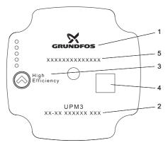
Fig. 5 Nameplate: Grundfos standard
