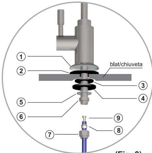
11. Înșurubați piulița de fixare (6) pentru a fixa bateria pe blat / chiuvetă.
