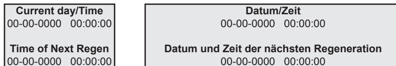
Wenn das Ventil im Meter-Modus (volumenabhängige Regeneration) programmiert ist, erscheint folgende Meldung auf dem Ventilschirm:
