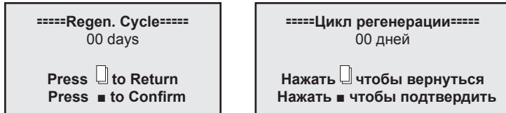
С фабрики данный параметр задается на 7 дней для *Timer mode* (Модуль регенерации в зависимости от времени) и на 10 дней для *Mix mode* (Модуля смешанной регенерации). Рекомендуется сохранять эти регулировки.
