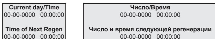
Если емкость запрограммирована в Meter mode (Модуль регенерации в зависимости от объема), на экране емкости будет выставлено следующее сообщение:
