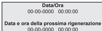
Qualora la valvola sia programmata in Meter mode (Modalità rigenerazione in funzione del volume), sullo schermo del rubinetto apparirà il seguente messaggio:
