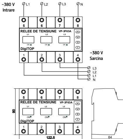
Releele de tensiune **VP-3F63A** sunt proiectate pentru a proteja împotriva oscilațiilor de tensiune pentru consumatorii monofazati sau trifazati cu capacitatea de a lucra ca un relee trifazic sau ca trei relee monofazice.
