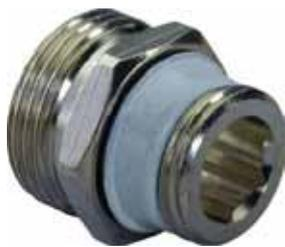
**Niplu redus Uponor** pentru racordarea la radiator cu ventil de 1/2 FI a racordului cu compresiune Cu 15x1 mm. Este din alamă cromată
