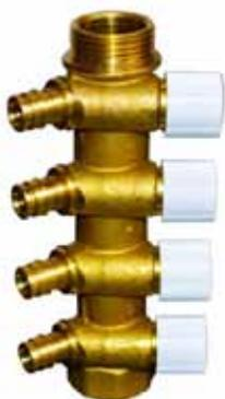
**Distributorul modular Uponor cu robineti Q&E DR** - 1 este din alamă DR (rezistentă la dezincare) cu filet 1 FE/FI și robineti de închidere pe fiecare circuit.
