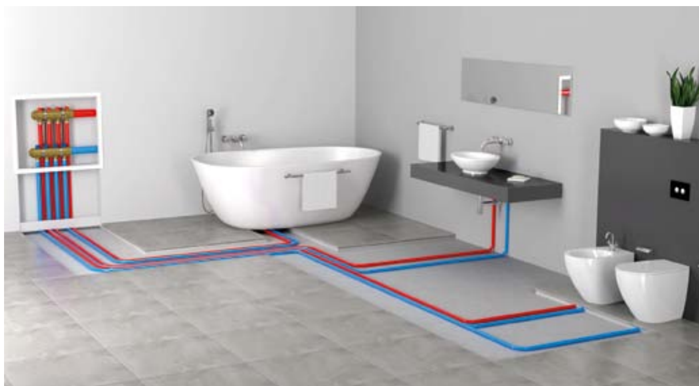
Sistemul sanitar realizat cu țevă multistrat preizolată sau cu teacă de protecție colorată
