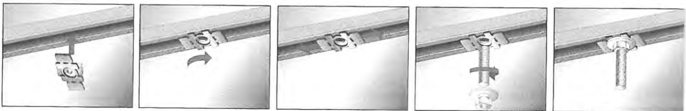
Figura 28. Montarea conectorilor FCN Clix P/M în șine de montaj FUS
