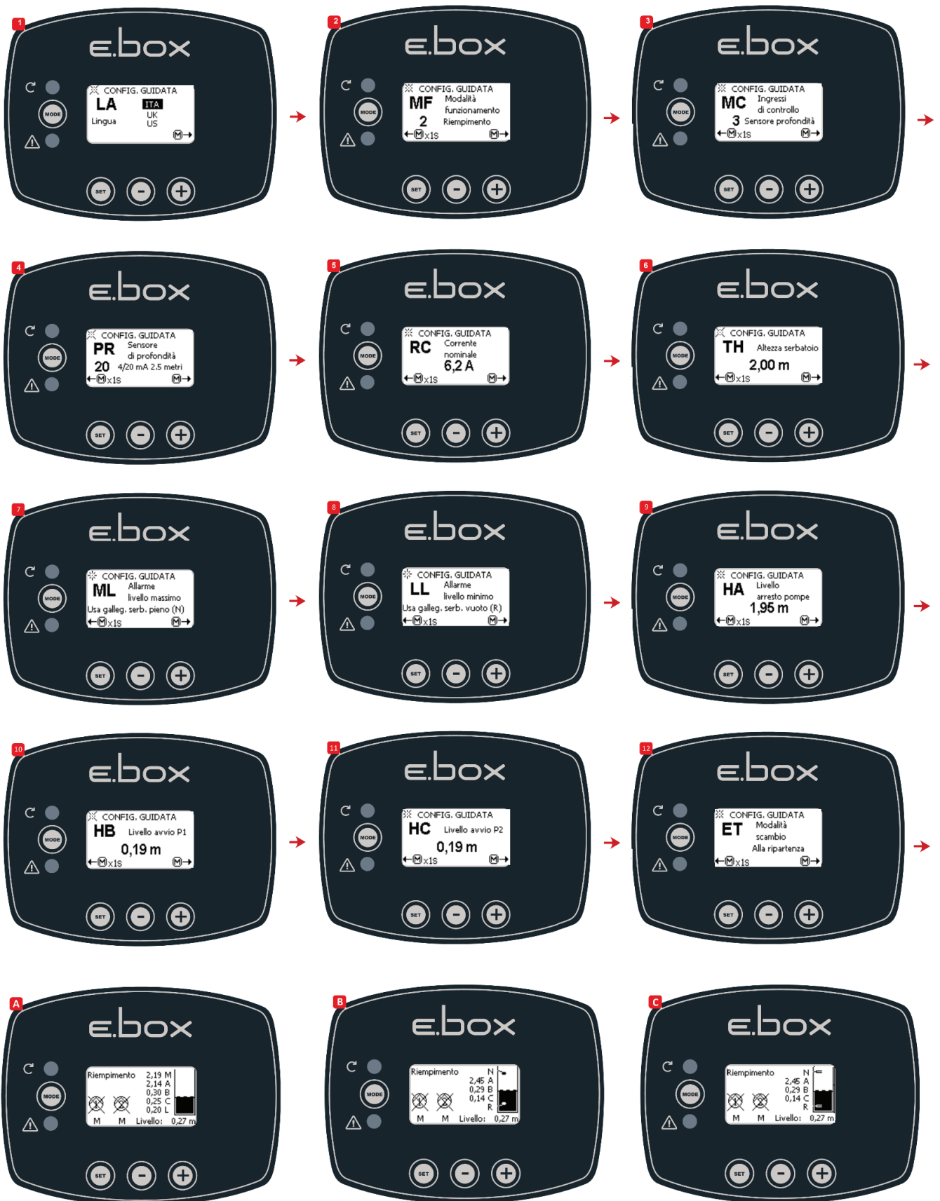
Figura 26: A Starea sistemului doar cu senzor de profunzime, B senzor de profunzime și plutitori, C senzor de profunzime și sonde de nivel
