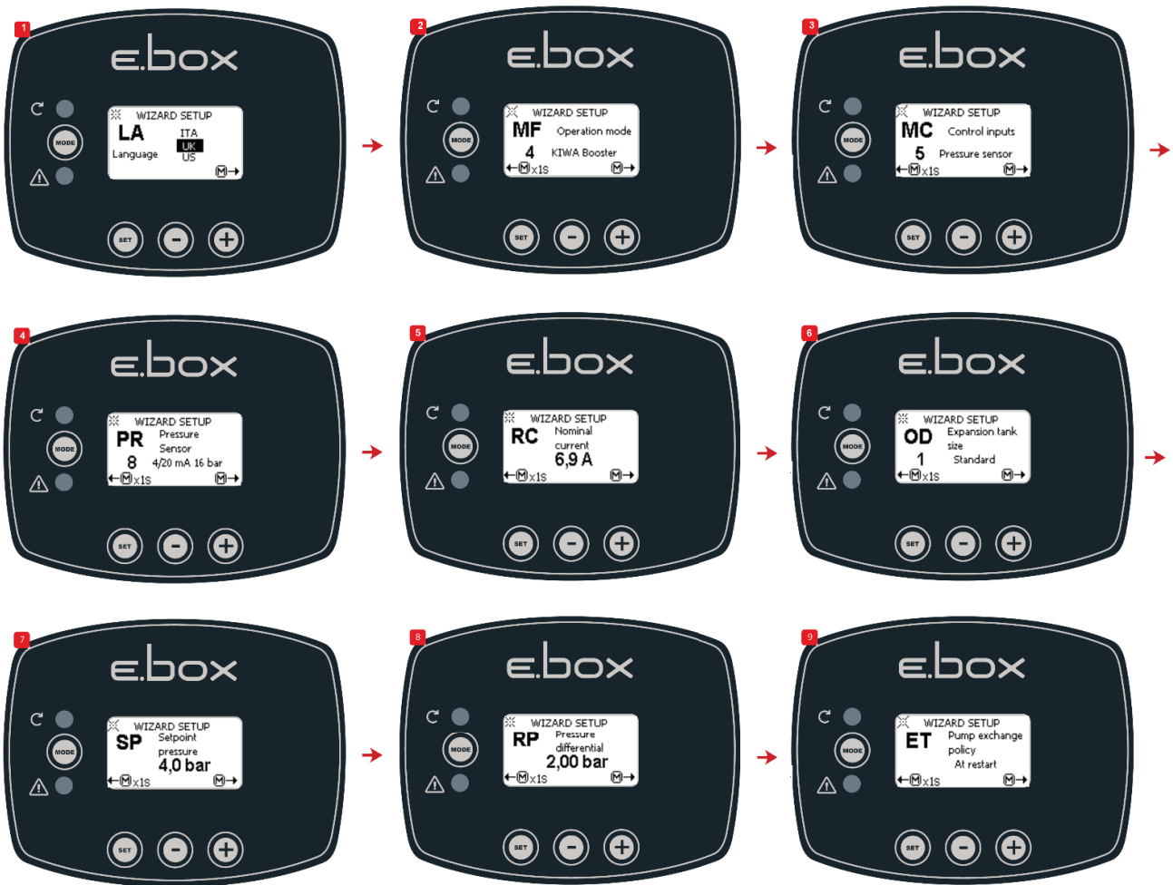
Figura 48: Presurizare KIWA cu senzor de presiune
