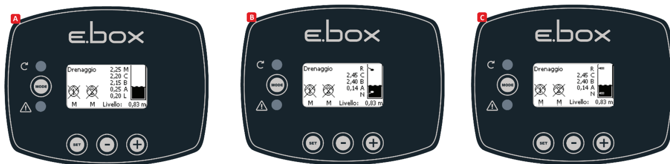
Figura 39: Starea sistemului în configurații A doar cu senzor de profunzime, B: senzor de profunzime și plutitori, C senzor de profunzime și sonde de nivel
