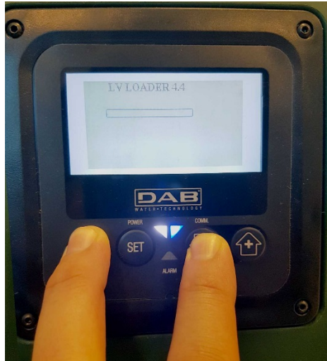
الشكل D9 -الوصول إلى "Loader" لتحديث "e.sybox mini3 Sw 1.X"
