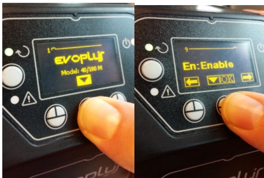
Figura 10- Configuración de software del módulo multifunción
