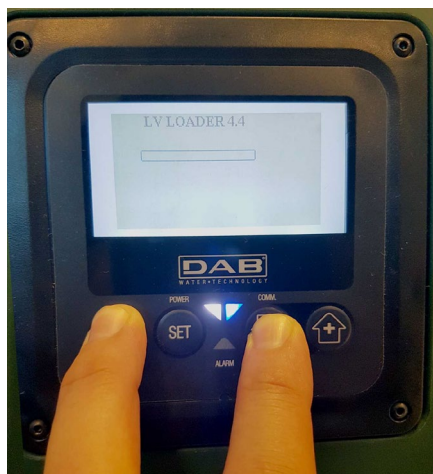
Figura 9C – Acceso al Loader para actualizar e.sybox
