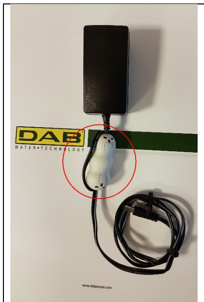
Image 11 - Position du Noyau de Ferrite
