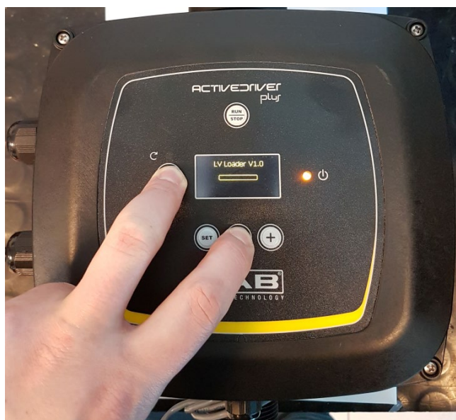
Рисунок 9В - Обновление Active Driver Plus ПО 1.X
