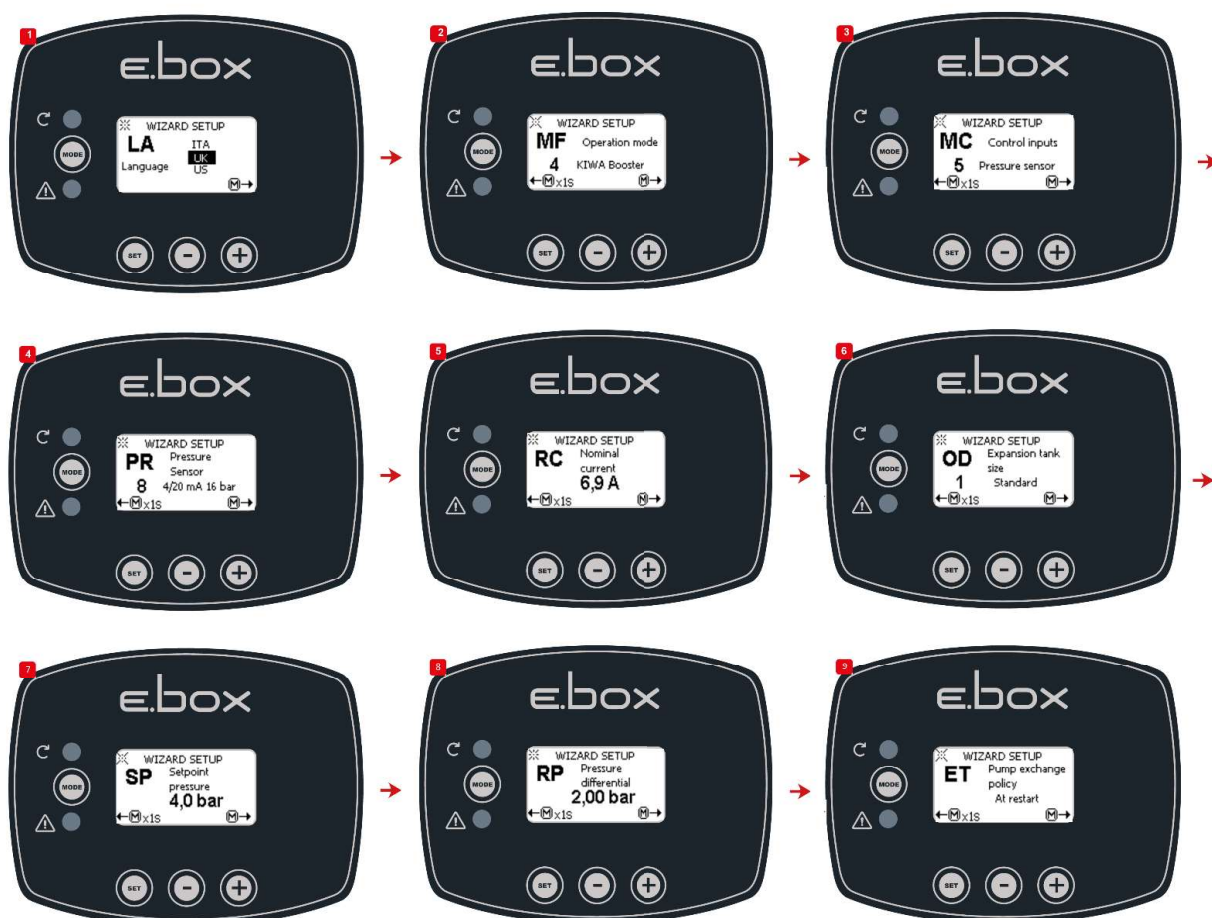
Figura 48: Presurizare KIWA cu senzor de presiune
