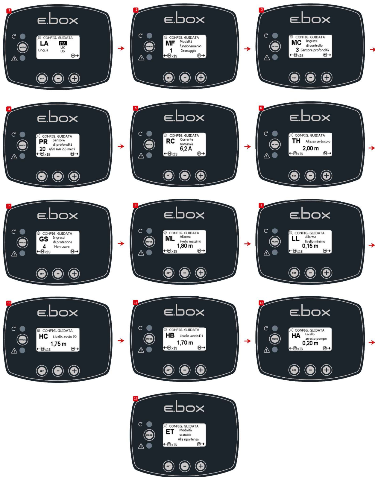
Figura 38: Configurare doar cu senzor de presiune
