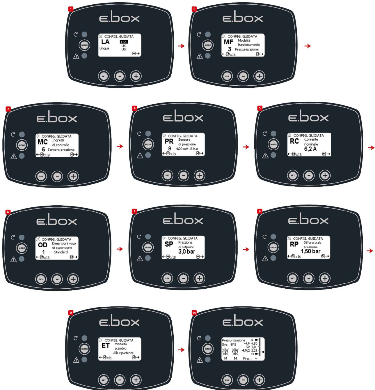
Figura 12: Configurare cu Senzor de presiune
