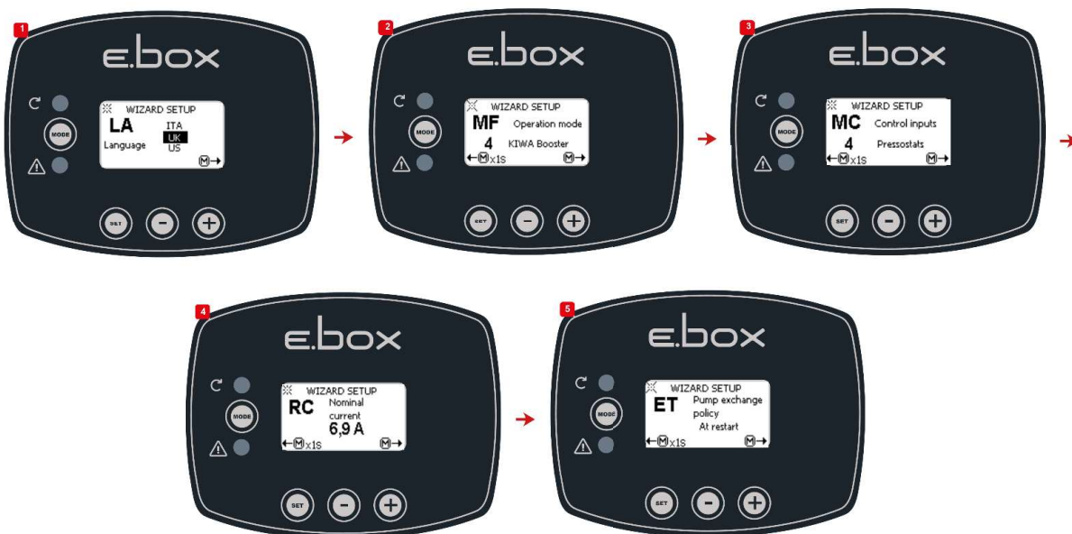
Figura 49: Configurare KIWA cu Presostați
