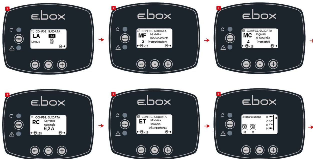
Figura 13: Configurare cu Presostați
