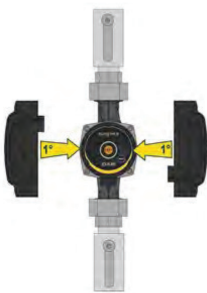
Figura 7: Izolare corp pompa
