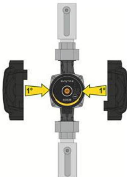
Figura 7: Izolare corp pompa
