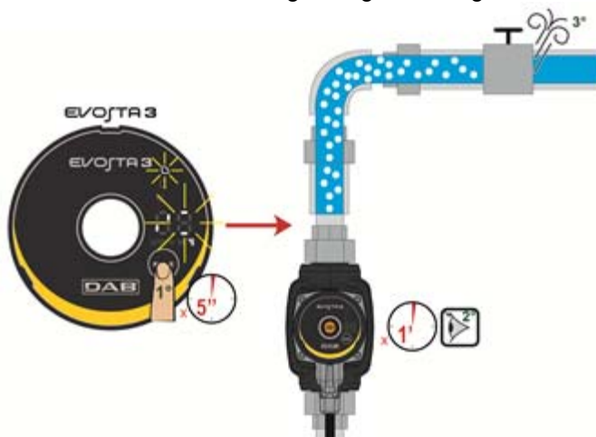
Fig. 9: Automatisk udluftning af pumpe
