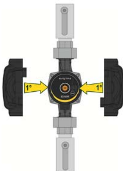
Afbeelding 7: Isolatie van het pomphuis
