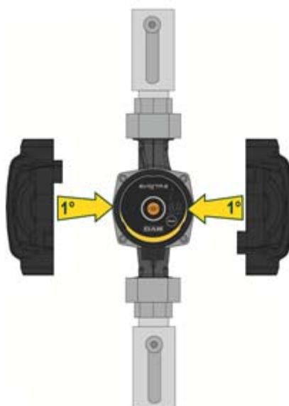
Figura 5: Aislamiento del cuerpo de la bomba
