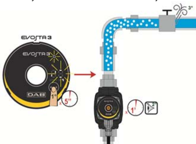
Obrázek 9: Automatické odvzdušnění čerpadla
