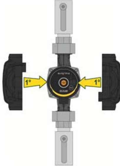
Resim 7: Pompa gövdesinin yalıtımı
