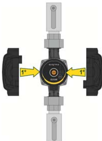
Figura 7: Izolare corp pompa
