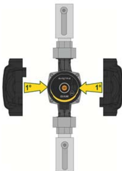
Fig 7: Isolering av pumphuset
