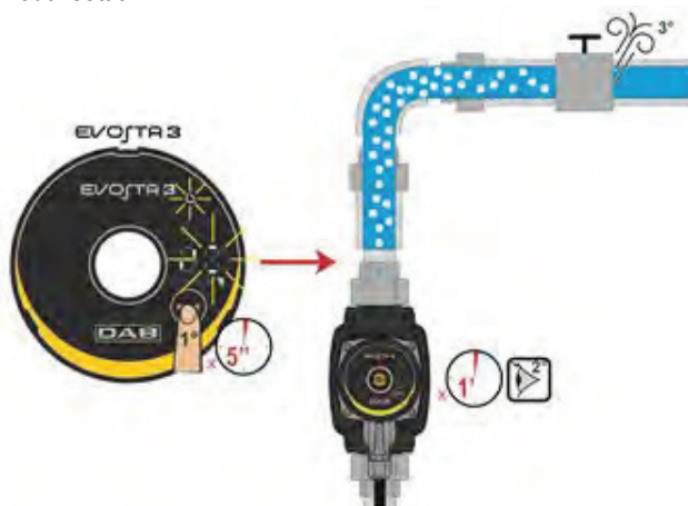
Figura 9: Aerisirea automată a pompei
