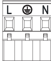
Figura 6: Cutie cu borne extractibilă de alimentare
