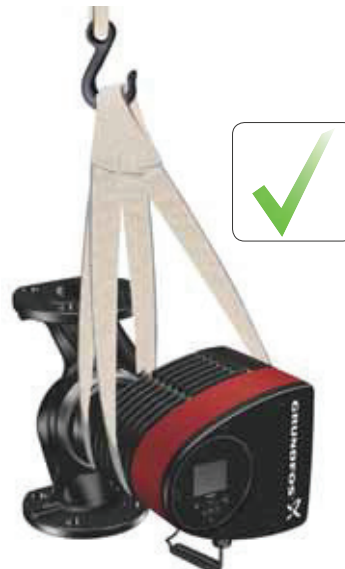
Fig. 1 Ridicarea corectă a pompei
