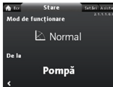
Fig. 59 Exemplu de submeniu "Stare de operare" prezentând pompa funcționând normal într-un sistem cu pompe multiple.
