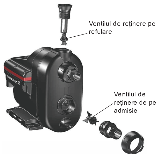
Fig. 20 Ventilele de reținere de pe refulare și alimentare
