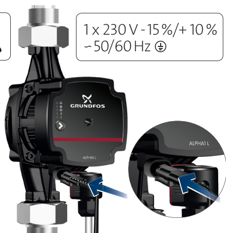
Conectarea cablului de semnal la ALPHA1 L
