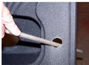
Fig. 5 Gaura finala este obtinuta prin utilizarea unei pile aspre
