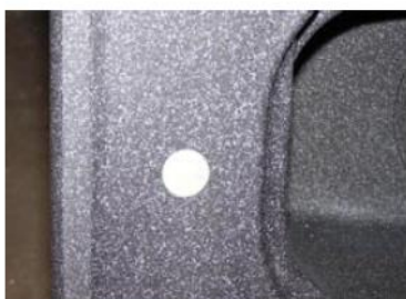
Fig. 1 Bulina care indica pozitionarea gaurii pentru baterie
