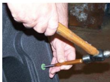
Fig. 3 Echipamentul necesar gauririi (dorn 8 mm + ciocan usor)
