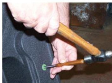
Fig. 3 Echipamentul necesar gauririi (dorn 8 mm + ciocan ușor)
