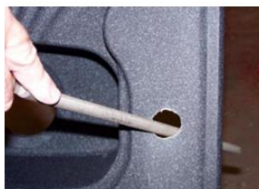
Fig. 5 Gaură finală este obținută prin utilizarea unei pile aspre
